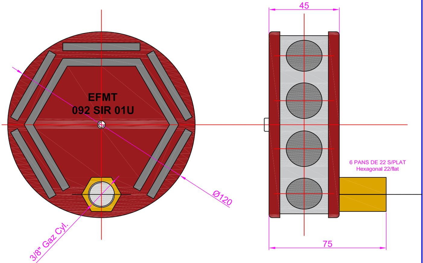
**Matière / Material** : Aluminium**Pression de fonctionnement** : 5 à 100 bar**Working pressure** : 5 to 100 bar**Fluide** : CO<sup>2</sup> ou Air Comprimé**Fluid** : CO<sup>2</sup> or Compressed Air**Finition / Finishing** : Rouge / Red**Poids / Weight** : 0,840 Kg
